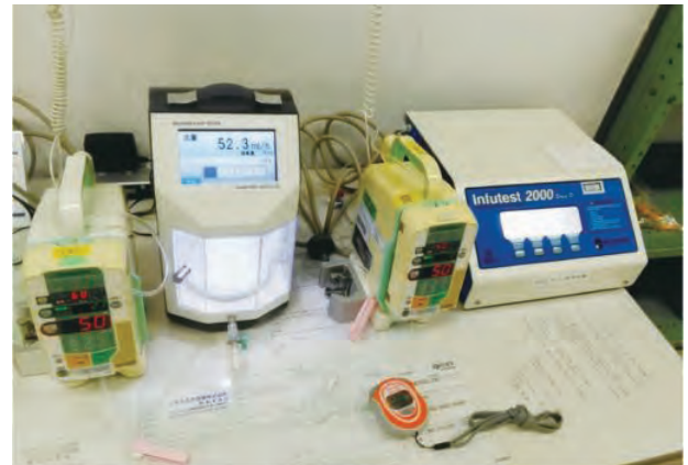
図2 実際の流量および閉塞圧測定の様子
